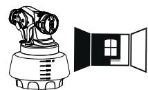
Объем материала может быть установлен путем поворота регулятора объема материала в позицию от 1 (минимум) до 12 (максимум) (рис. 11, 1).
